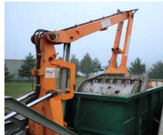
Le Syndicat est équipé d'un compacteur (packmat) permettant de réduire d'environ 30% le nombre de rotations de bennes, **soit un gain de 335 rotations/an.**
